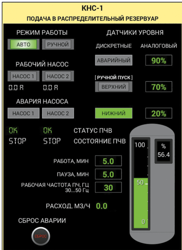
Рис. 3. ПРИМЕР РЕАЛИЗАЦИИ СИСТЕМЫ КОНТРОЛЯ УРОВНЯ ЖИДКОСТИ В УСРЕДНИТЕЛЕ (ГИДРОСТАТИЧЕСКИЙ ДАТЧИК УРОВНЯ)
