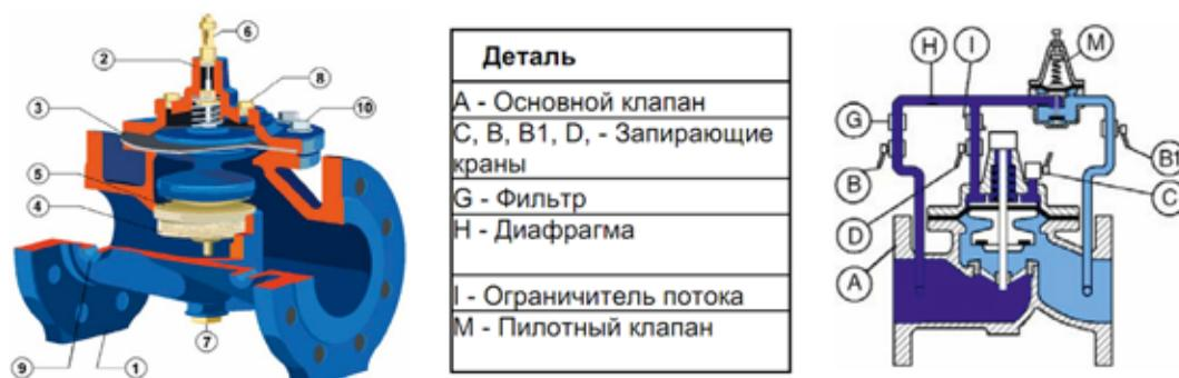
**Рис. 6. Внешний вид регулятора давления SOCLA C101 (DANFOSS). Принцип действия**
