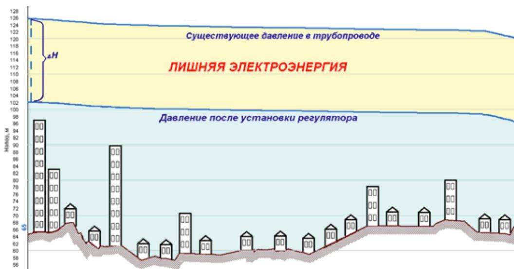
После анализа результатов были выбраны 12 районов города, в которых целесообразна установка регуляторов давления (рис. 5). Для монтажа использовали регуляторы давления Socla C101 компании Danfoss.
