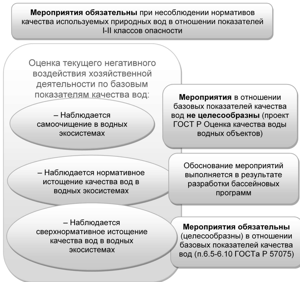
Рисунок А.1 – Общий порядок обоснования целесообразных водоохранных мероприятий
