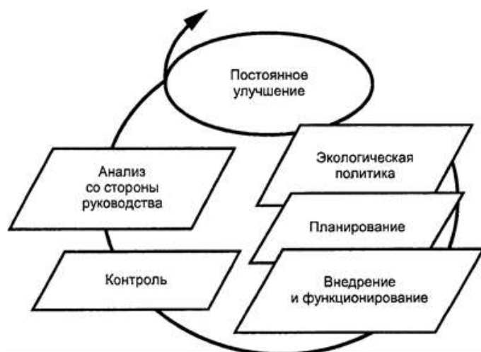
Рисунок 1 – Петля качества мероприятий по постоянному улучшению в соответствии с ГОСТ Р ИСО 14001 (версия 2007 г.)
